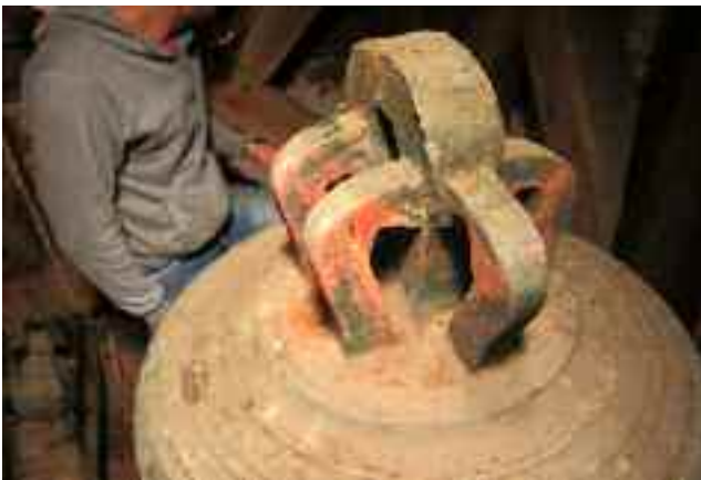
Die Aufhängung der Glocken, die sogenannte Krone, war 2011 besonders rechts im Vordergrund auf ein Drittel der ursprünglichen Stärke reduziert.
